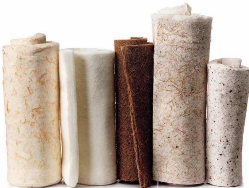
Cellupress, ett material gjort av fibrer från gran och PET-plast, som används till Lammhults stol "Imprint".
