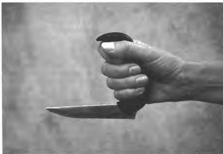
Bild: Ergonomisk kniv för personer med nedsatt greppförmåga
